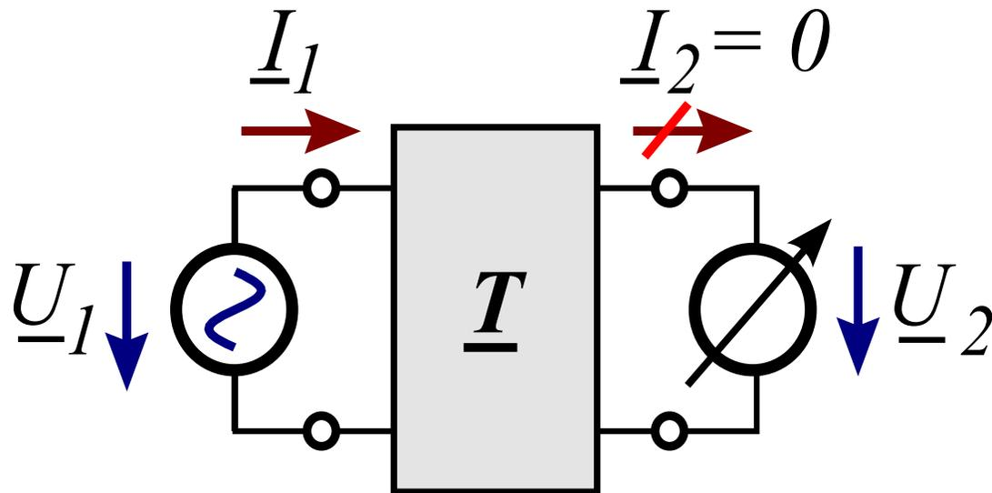
Randbedingungen bei der Berechnung einer Übertragungsfunktion. Die Übertragungsfunktion  $\underline{T}$  beschreibt eine unbelastete Schaltung an einer idealen Wechselspannungsquelle
