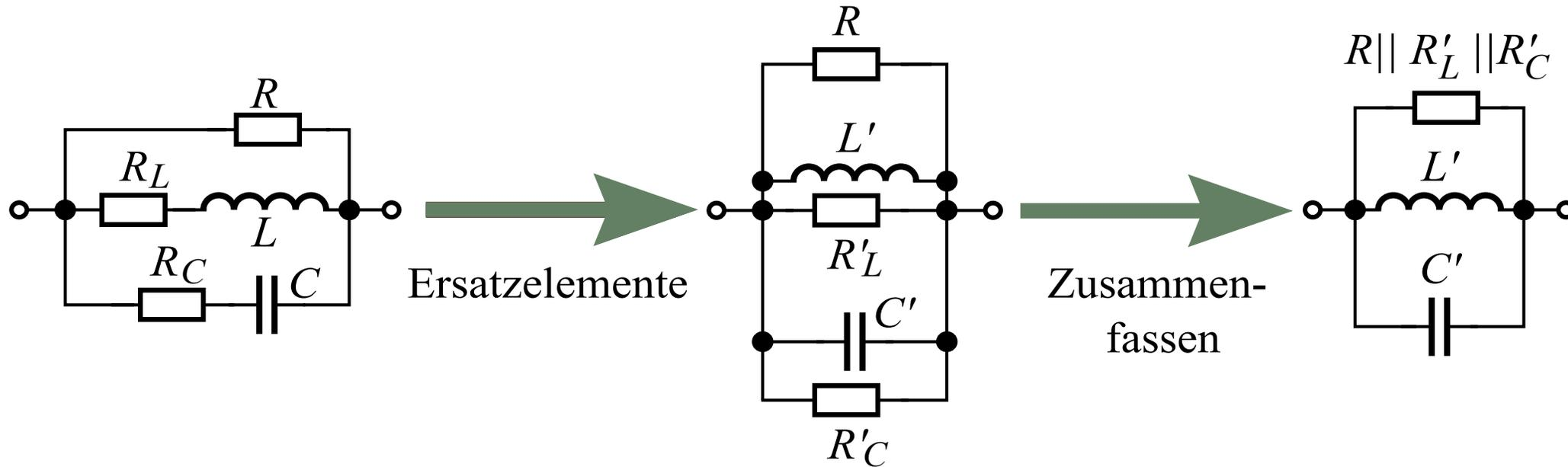
Konstruktion des Parallel-Ersatz-Schwingkreises:
