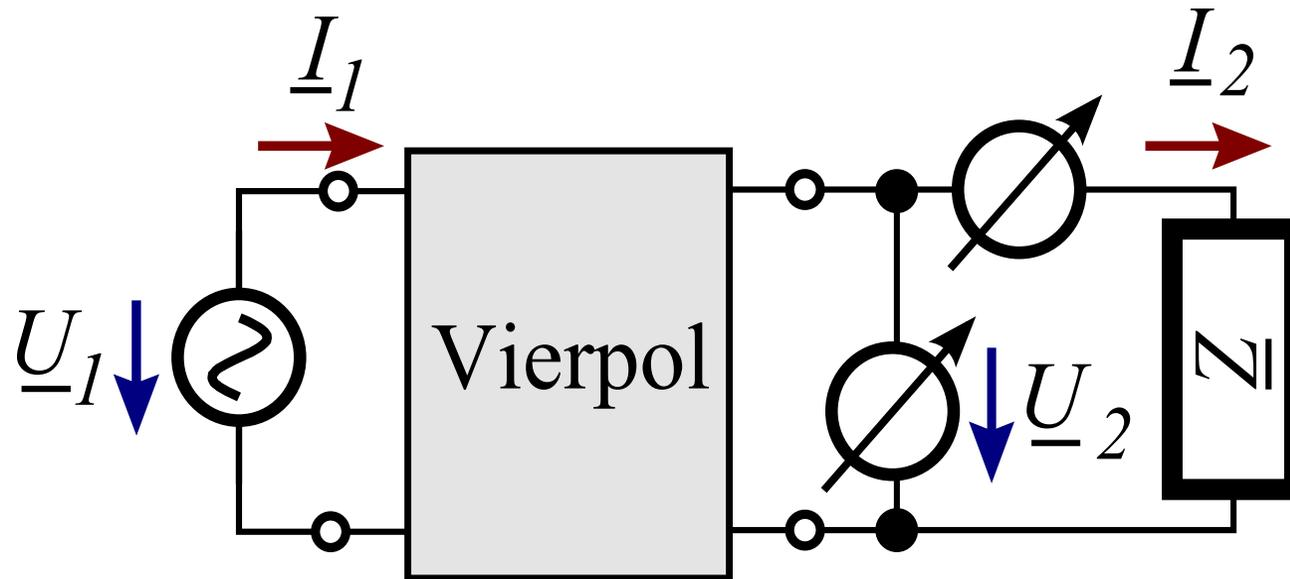
Die von außen sichtbaren komplexen Amplituden an einem Vierpol.
