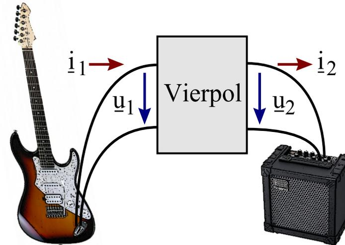
Beispielschaltung vor und nach dem Einbau eines Vierpols: ein Verstärker mit Zusatzlautsprecher. Hier könnte der Vierpol für ein Verzerrpedal stehen.
