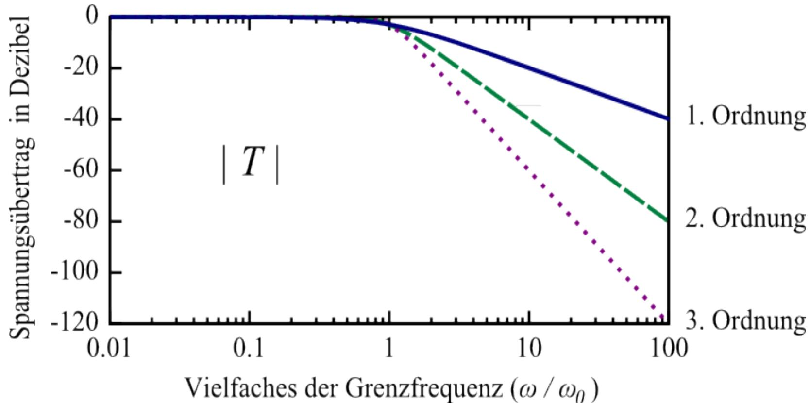
Spannungsübertrag für drei Potenzfilter. Alle Kurven gehen durch den Punkt  $(\omega / \omega_0, T) = (1, -3\text{dB})$ . Andere Typen von Tiefpass-Filtern sehen an den  $\omega / \omega_0$ -Rändern bei gleicher Ordnung gleich aus.
