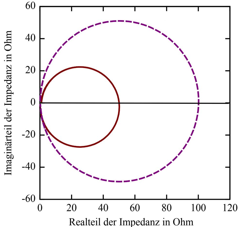
Ortskurve eines Parallelschwingkreises mit  $R = 100 \Omega$   $L = 100 \mu\text{H}$  und  $C = 1 \mu\text{F}$  für den Fall einer idealen Spule (außen) und mit einem Ohm'schen Spulenwiderstand  $R_L$  (innen). Die maximale Impedanz ist reduziert, und bei hohen Frequenzen werden  $0 \Omega$  nicht mehr ganz erreicht
